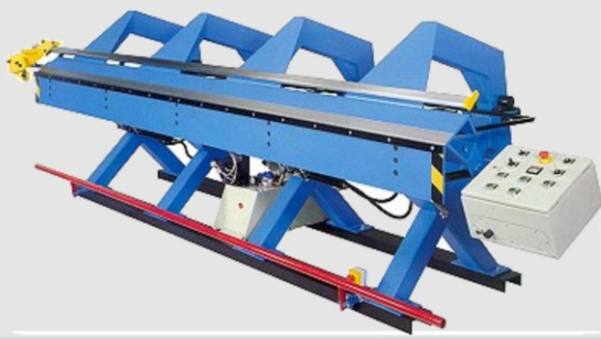
Fălțuitorul lung pentru table se poate folosi pînă la grosimea de 1,25mm.
