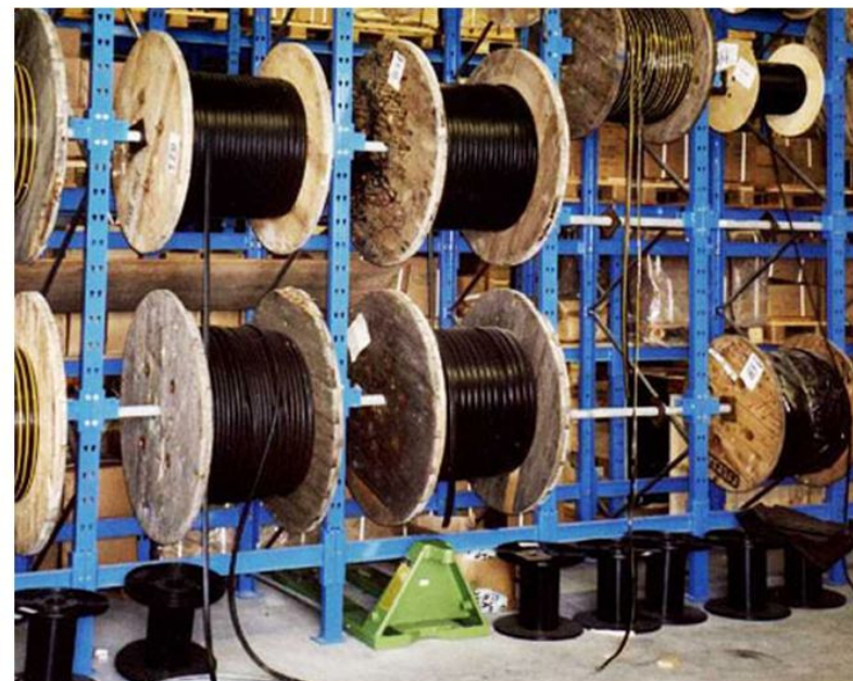
Rafturi depozitare pentru role de cablu
