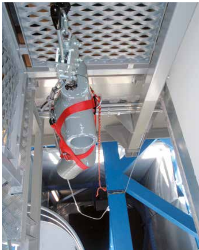
Test de cădere al unui ham complet.
