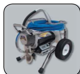
Rama utilajului Lo-Boy posedă un suport pentru furtun, atașat permanent
