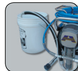
Conducta de aspirare îndoită protejează împotriva răsturnării rezervorului.
