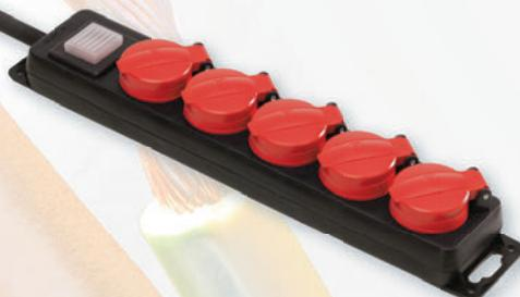
Anschlussleitung H07RN-F 3G1,5, 4,5 m, Schutzkontaktstecker 230 V / 16 A, selbstschließende Deckel, für Wandmontage geeignet, beleuchteter Schalter, IP44, geprüft nach VDE 0620-1, VDE 0285-525-2-21
