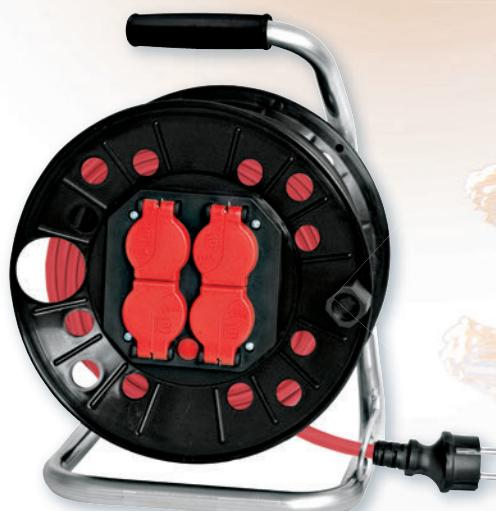
Gummikabel H07RN-F 3G1,5, Kabelfarbe rot, Kunststoff-Trommelkörper ø 290 mm, verzinktes Bügelgestell Schutzkontaktstecker 230 V / 16 A, 4 x Schutzkontaktsteckdose mit Klappdeckel, max. 3,5 kW, Thermoschutzschalter mit Wiederanlaufschutz, IP44, geprüft nach EN 61242, DIN VDE 0620-1, DIN EN 50525-2-2. Durch die spezielle Formgebung kein Abgleiten der Leitung hinter die Trommel. Serienmäßig mit patentierter Kabelführung ausgestattet.
