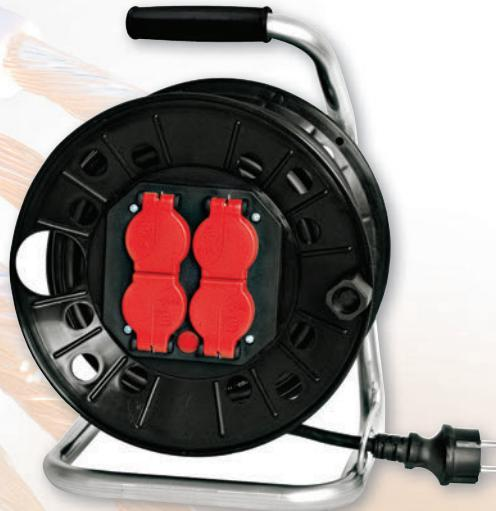
Gummikabel H07RN-F 3G2,5, Kabelfarbe schwarz, Kunststoff-Trommelkörper ø 290 mm, verzinktes Bügelgestell Schutzkontaktstecker 230 V / 16 A, 4 x Schutzkontaktsteckdose mit Klappdeckel, max. 3,5 kW, Thermoschutzschalter mit Wiederanlaufschutz, IP44, geprüft nach EN 61242, DIN VDE 0620-1, DIN EN 50525-2-2. Durch die spezielle Formgebung kein Abgleiten der Leitung hinter die Trommel. Serienmäßig mit patentierter Kabelführung ausgestattet.
