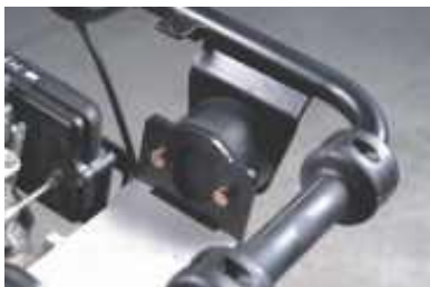
Sistem de amortizare a vibrațiilor, supradimensionat, ce reduce nivelul vibrațiilor resimțite de utilizator, crescând astfel confortul operatorului.
