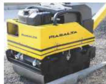
Sistemul îngust de prindere al cilindrului permite compactarea în apropierea bordurilor, a zidurilor și a altor obstacole.
