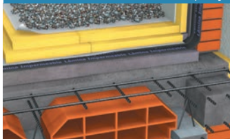
Acoperiș fără trafic (cu balast)
